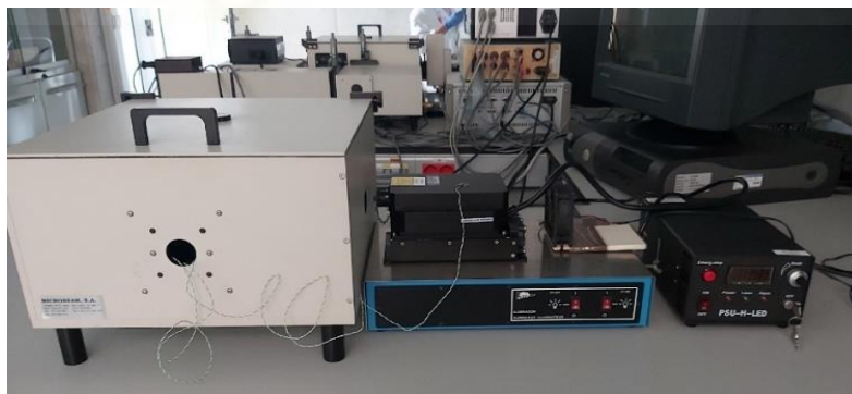
Figura 8. Esquema del montaje del equipo de irradiación de nanopartículas.
