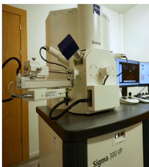
Figura 7. Microscopio electrónico de barrido de emisión de campo (FESEM) modelo SIGMA 300 VP de ZEISS.
