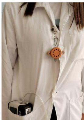
**Figura 5.** Colocación del captador en el uniforme del personal sanitario encargado de realizar la broncoscopia. Fotografía tomada en el laboratorio.
