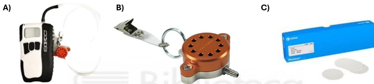
**Figura 4.** A) Captador personal de solapa “Personal Impactors Model 200” con cabezal PM<sub>10</sub>. Fotografía tomada en el laboratorio. B) Cabezal PM<sub>10</sub>. Imagen tomada de Internet. C) Filtros de cuarzo (Whatman 37 mm). Imagen tomada de la página web de Fisher Scientific [19].
