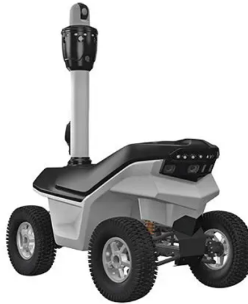
Figura 1-3: Robot móvil S5 Series de SMP Robotics Systems empleado para tareas de vigilancia y seguridad https://smrobotics.com/ .
