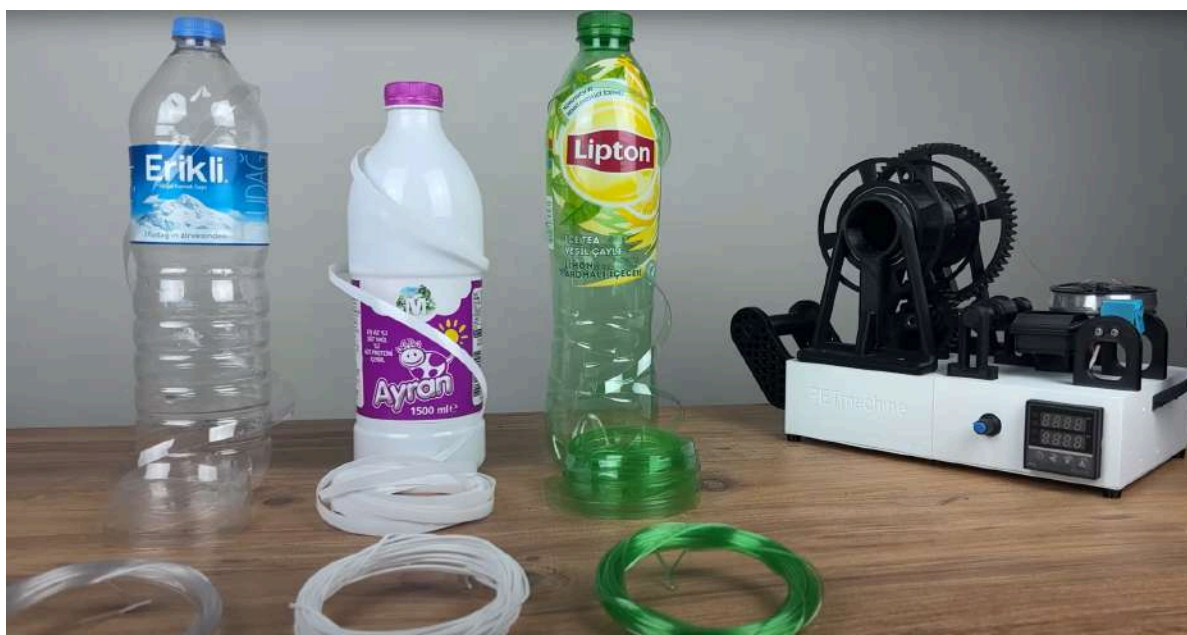
Figura 23: Distintos filamentos creados con botellas de plástico dispuestos para impresión 3D.
