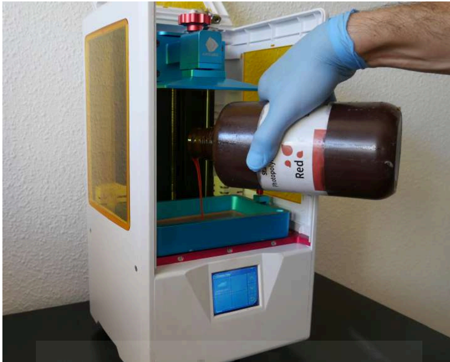
Figura 4: Impresora Anycubic 3D Photon S siendo cargada con resina líquida fotosensible.
