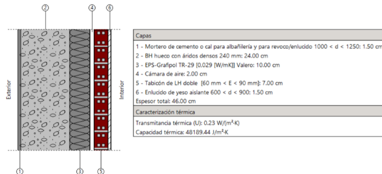
Figura 4.5: Composición de la fachada
