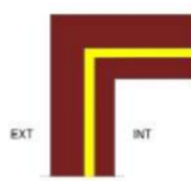
Figura 4.30: Puentes térmicos: esquina saliente
