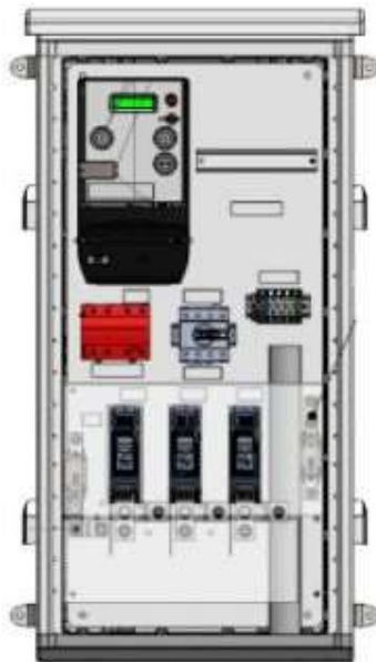
Ilustración 36 - Caja Protección y Medida
