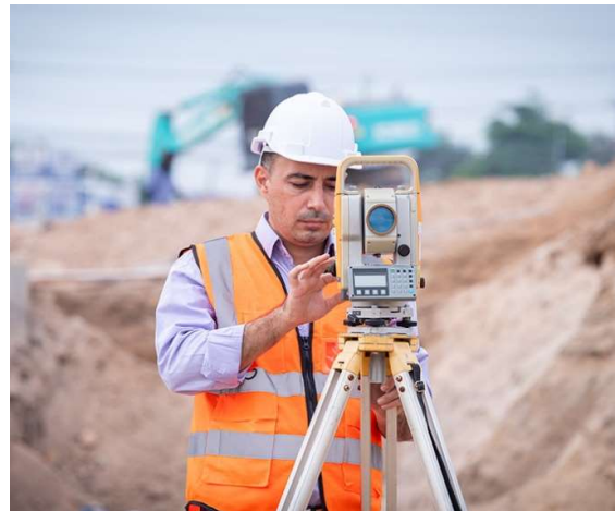
Ilustración 50 - Equipo topográfico para estudio de replanteos
