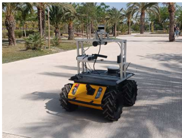
Figura 7.2: Plataforma Husky con los sensores instalados.
