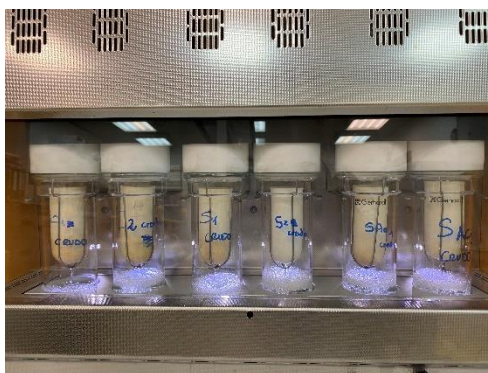
Figura 24. Extracción de lípidos (Soxhlet J.O Selecta S.A.).
