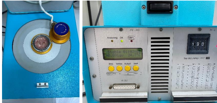
Figura 26. Medición de actividad de agua.
