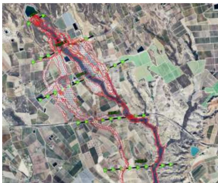
Figura 12: Vista de las secciones transversales de la 1-5.
