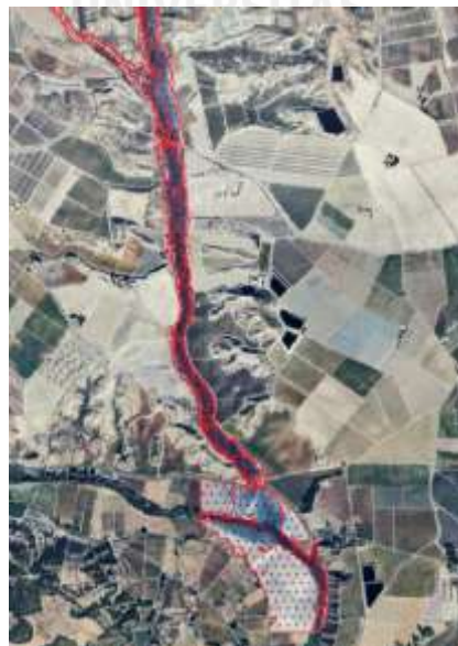
Figura 11: Vista de la zona de inundación en el cauce del Barranco del Galán y su llegada al río Segura. (Fuente, elaboración propia)
