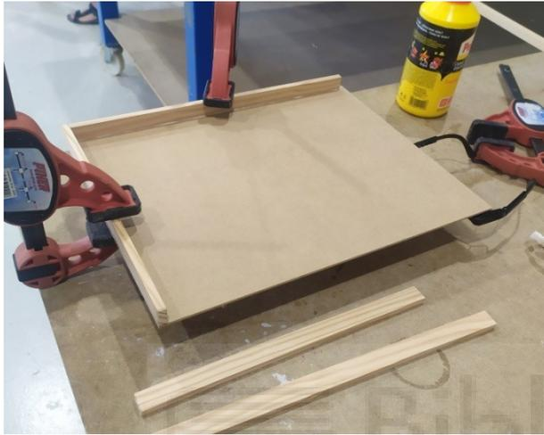
Fig. 11. Proceso de realización de los marcos de madera
