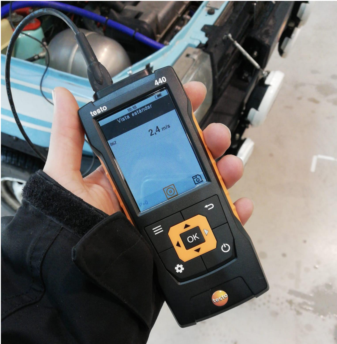
Ilustración 1-8. Medición de velocidad del aire a 4000rpm
