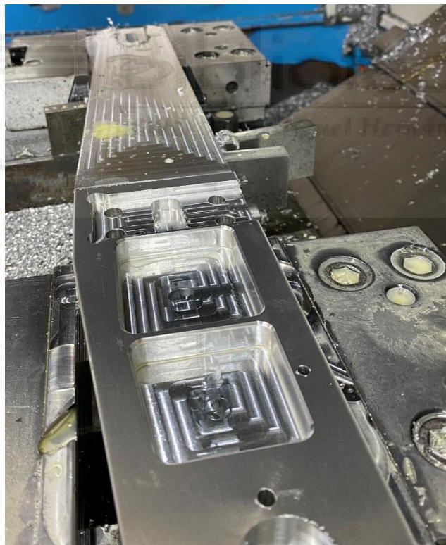
Ilustración 39 - Mecanizado de brazo izquierdo
