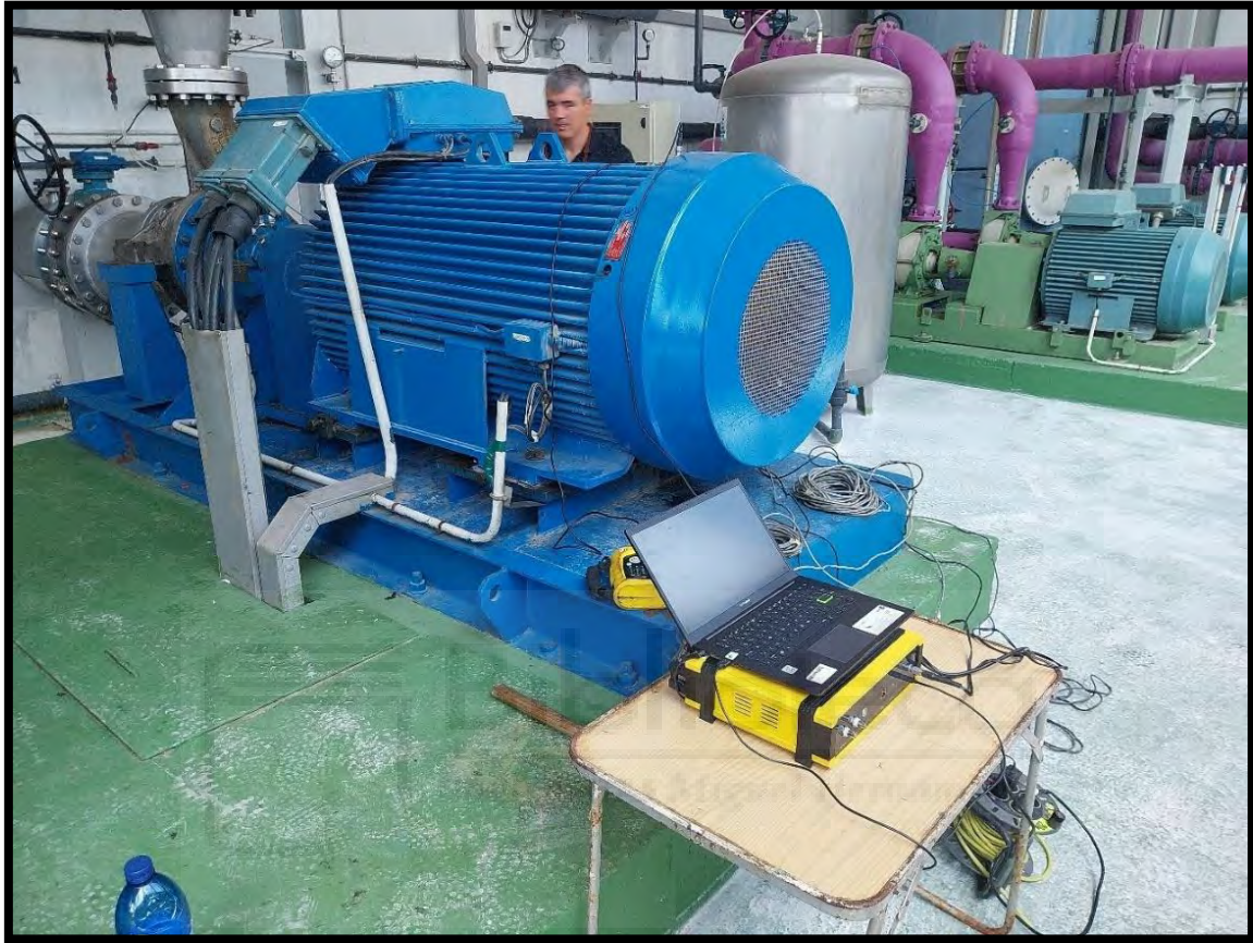
Ilustración 17-2: Foto del equipo en el ensayo de impacto.
