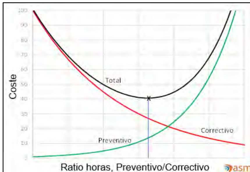
Ilustración 4-1: Gráfica del punto óptimo de actuación sobre el equipo.
