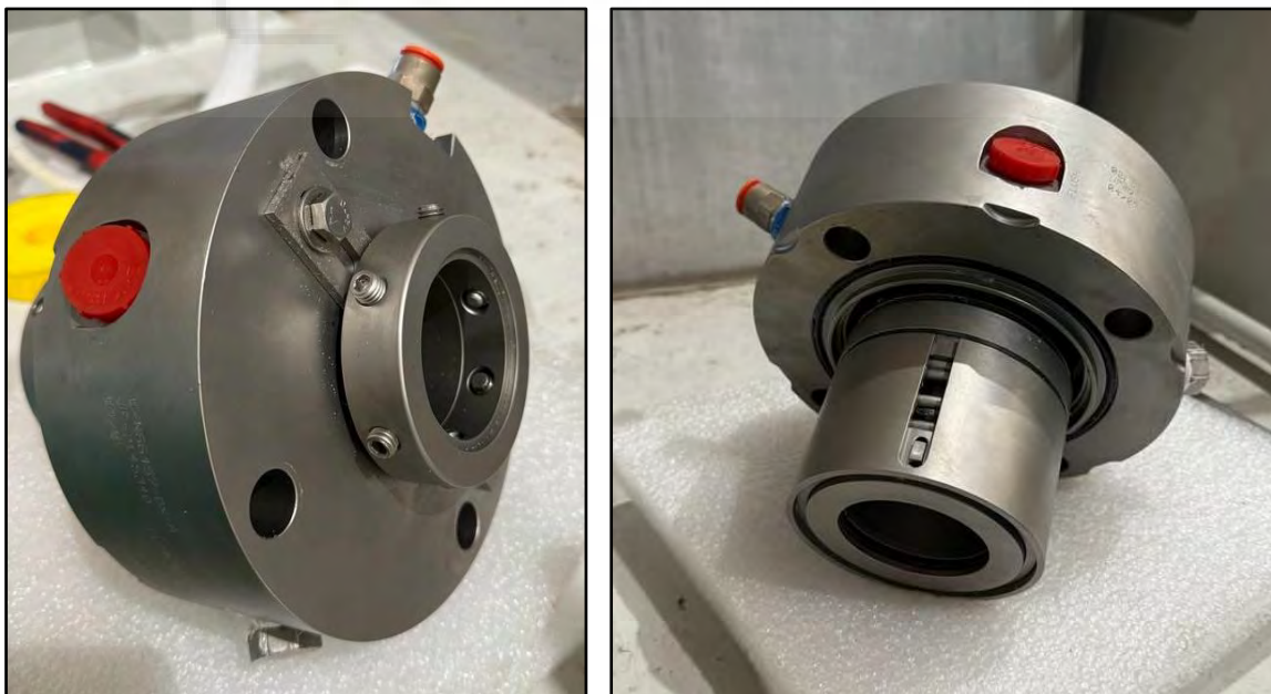
Ilustración 11-2: Cierre mecánico de una bomba de alta presión.
