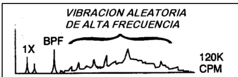
Ilustración 13-17: Espectro de la cavitación.
