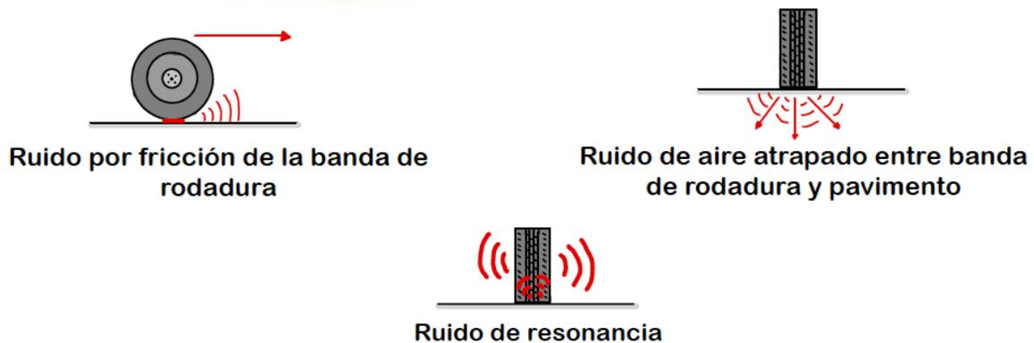
Figura 5: Fuentes de ruido en la rodadura. Fuente: elaboración propia.
