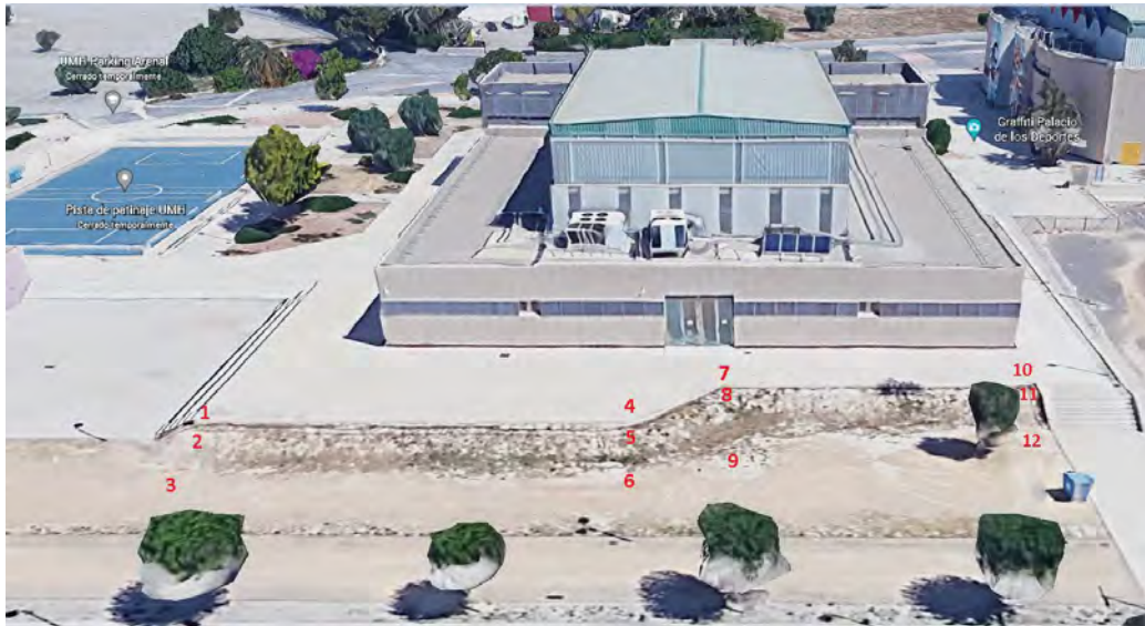
Figura n° 18. Representación de los puntos en los que se han tomado las medidas de altura con el nivelador óptico. Fuente: Google Earth.
