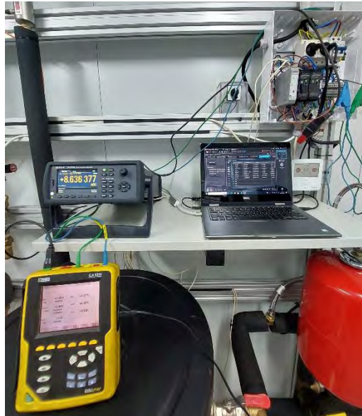
Figura 76. Uso analizador de redes
