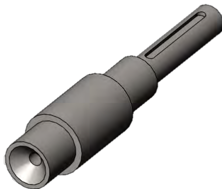
Figura 15: Acople del eje del lado del motorreductor.
