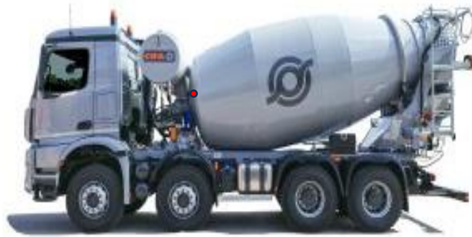
Figura 8. Camión hormigonera y centro de gravedad aproximado.
