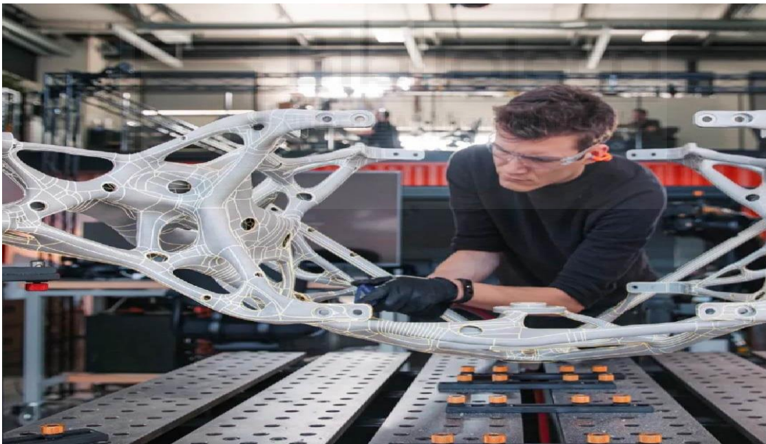
Figura 6. Retocando chasis de moto impresa en 3D [9].
