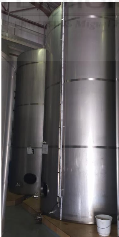
Ilustración 16. Ejemplo de depósito de acero inoxidable utilizado en las almazaras con boca de hombre, grifo sacamuestras y tapa de apertura superior
