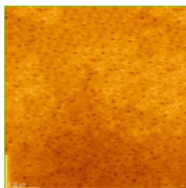
Figura 2.59. AFM en modo de altura de la capa activa (\text{ZnPc})_2\text{-DPP 1}/\text{PC}_{70}\text{BM} depositada en cloroformo; la rugosidad RMS es 1.7 \text{ nm}^2 .
