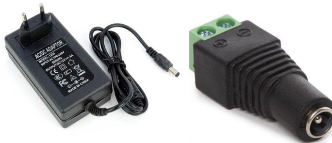
Ilustración 17. Fuente de alimentación del pestillo eléctrico y su adaptador
