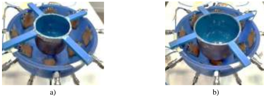
Fig 3.74. Modelos metalizados: a) modelo pequeño; b) modelo grande.
