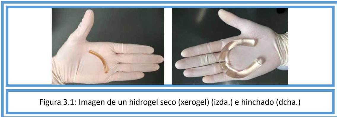
Figura 3.1: Imagen de un hidrogel seco (xerogel) (izda.) e hinchado (dcha.)
