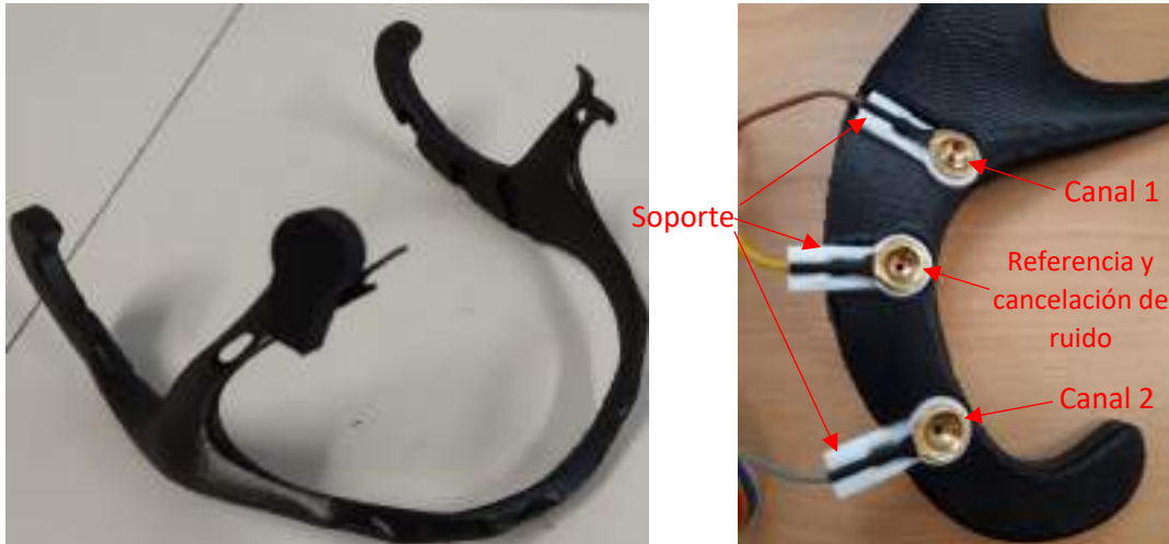
Figura 4.4. Diadema fabricada mediante impresión 3D.
