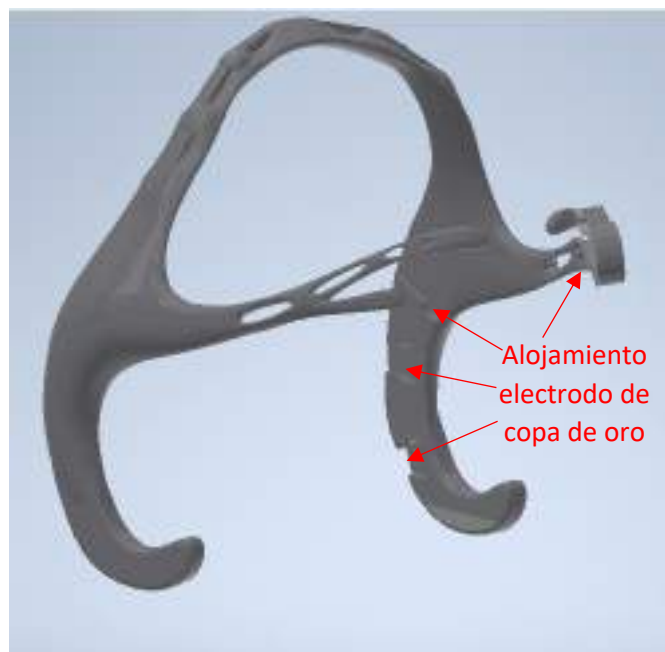
Figura 4.3. Modelo de la Diadema con electrodos diseñado con Inventor.
