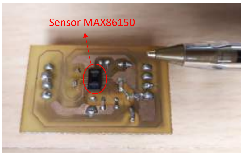
Figura 3.14. PCB del sensor MAX86150 (ECG y PPG).
