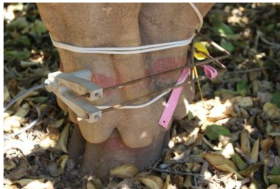
Figura 5. Detalle del dendrómetro de tronco utilizado en el ensayo.
