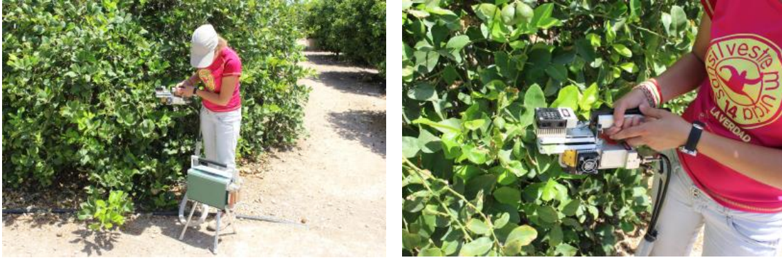
Figura 4. Analizador portátil de fotosíntesis (Li-6400, Li-Cor, Lincoln, NE, USA).
