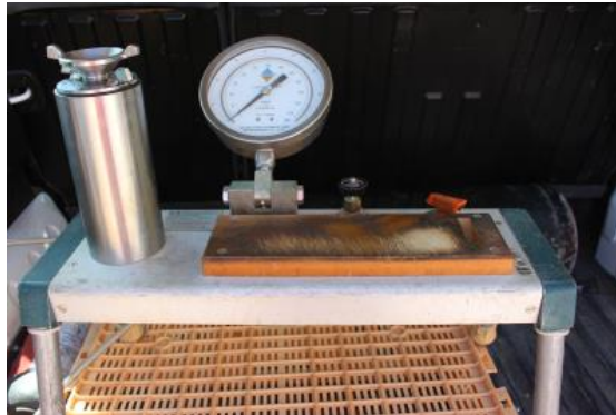
Figura 3. Cámara de presión (model 3000; Soil Moisture Equipment Corp., Santa Barbara, California, USA).
