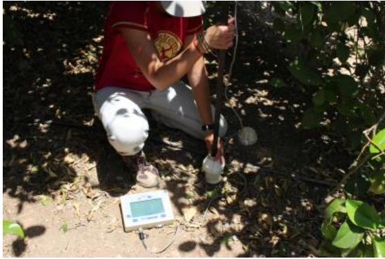
Figura 1. Sonda de Capacitancia o FDR (Diviner 2000, Sentek Sensor Technologies, Stepney, Australia).
