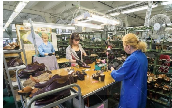
Figuras 9 y 10: Aplicación de crema para abrillantar el zapato. Tratamiento de acabado 9 10 .
