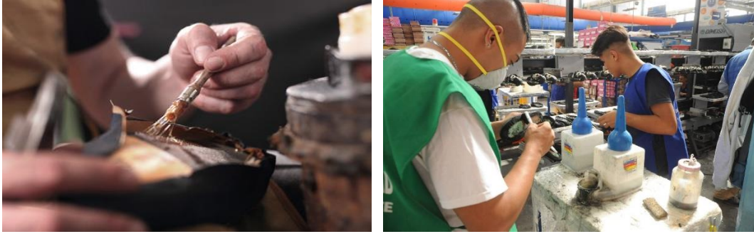
Figuras 5 y 6: Pegado del corte con plantilla sobre la horma 5 . Se aplica con brocha 6 .
