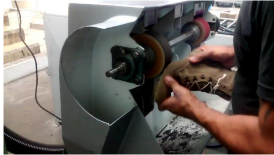
Figura 8: Lijado en la base del corte del zapato 8 .
