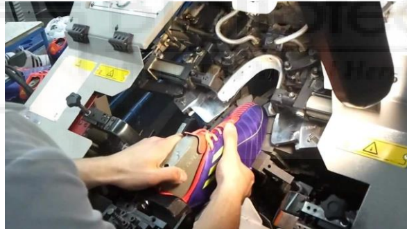
Figura 7: Montado de puntas en máquina 7 .
