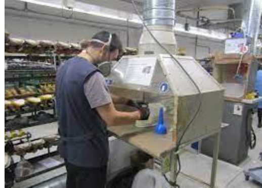
Figuras 16 y 17: Partes del sistema de extracción localizada y cabina de extracción localizada 3839 .
