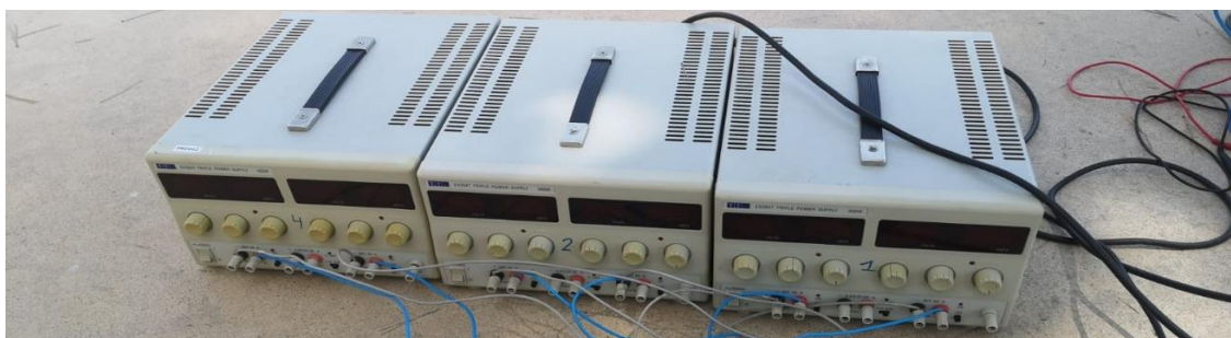
Ilustración 154: Fuentes de alimentación ensayo con hidrógeno
