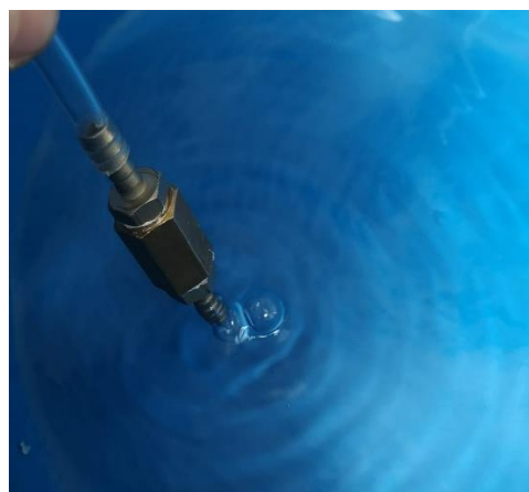
Ilustración 126: Salida de hidrógeno con 18A y 12V
