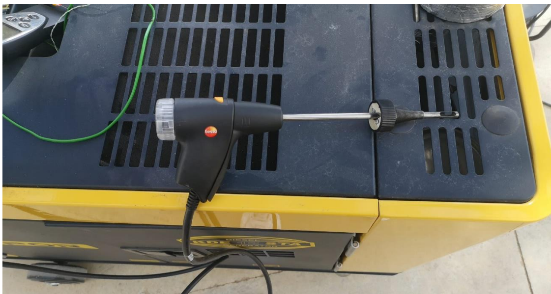
Ilustración 156: Equipo de medición de gases
