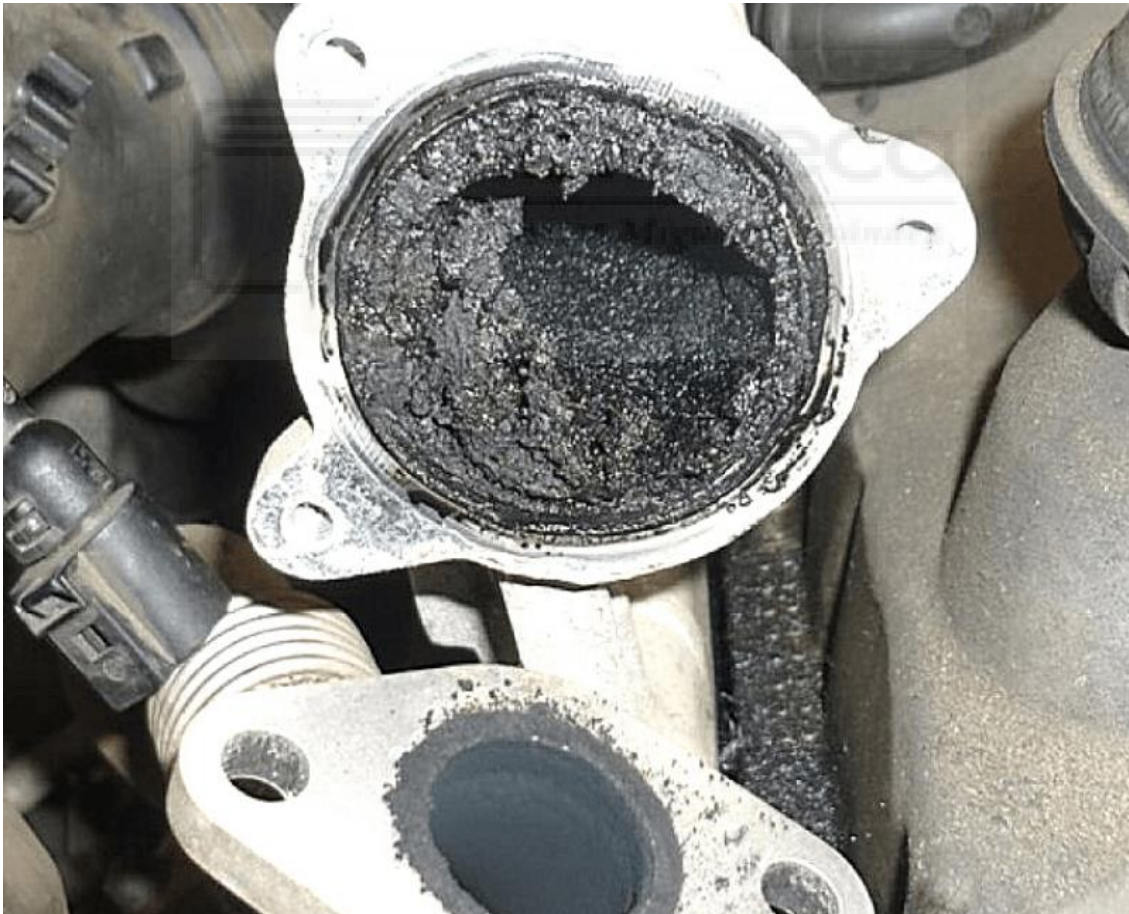
Ilustración 43: Acumulación de carbonilla en catalizador
