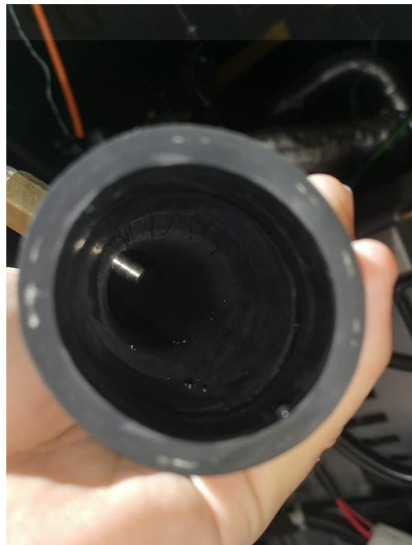
Ilustración 146: Comprobación interior punto de inyección manguito
