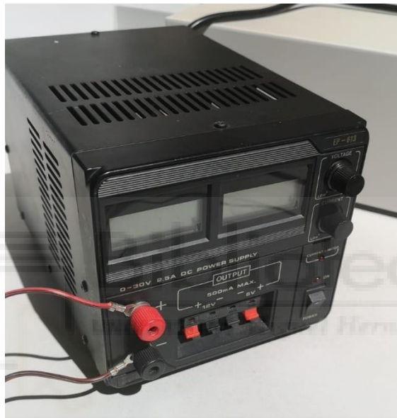
Ilustración 119: Fuente de alimentación 12V y 2,5A
