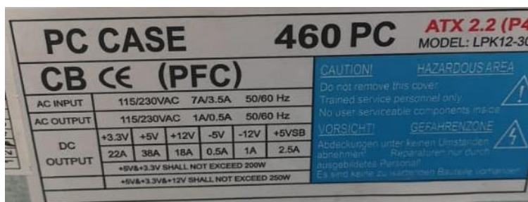
Ilustración 124: Ficha técnica fuente de alimentación ordenador
