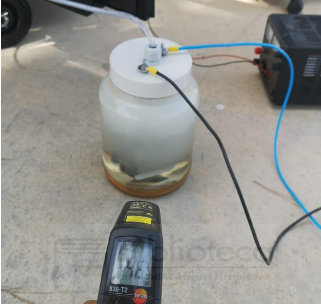
Ilustración 155: Control Temperaturaeratura de la celda durante el ensayo
