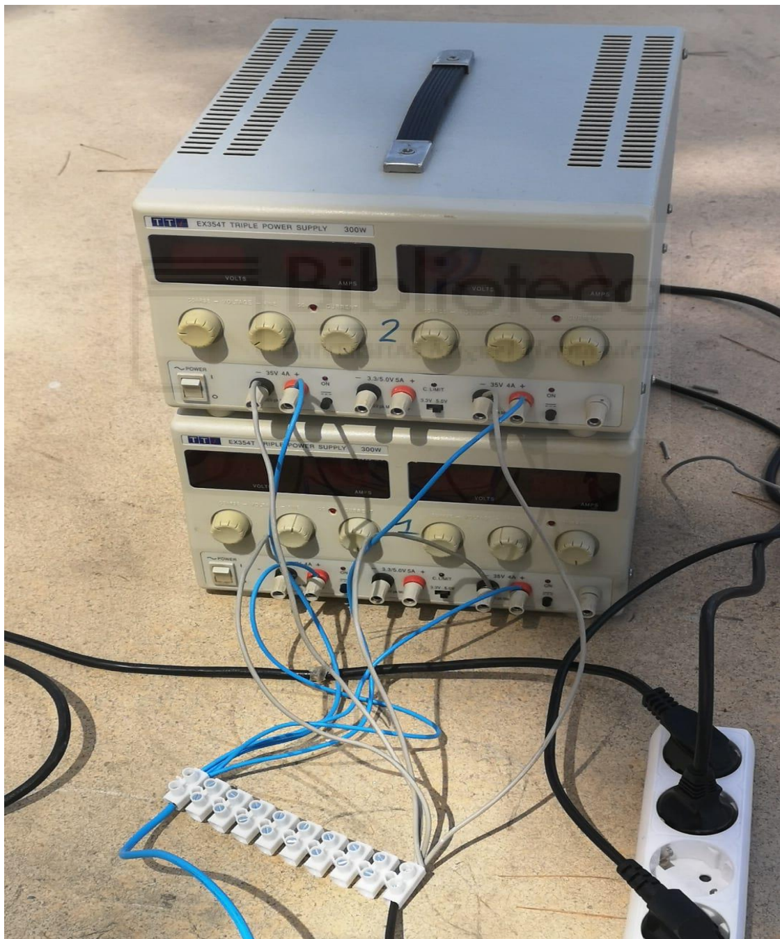
Ilustración 127: Conexión en paralelo de dos fuentes regulables
