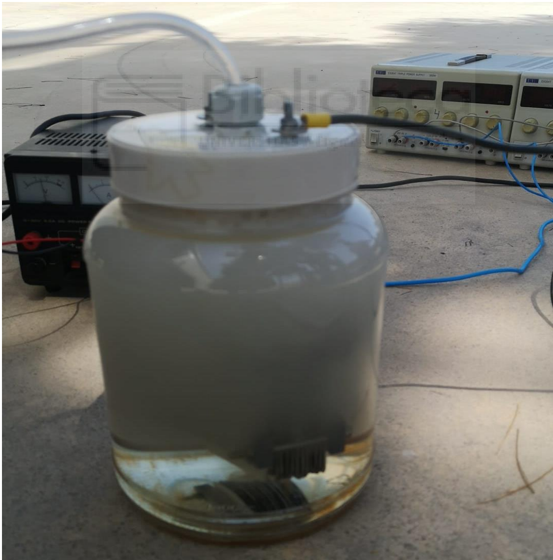
Ilustración 130: Producción de hidrógeno con 3 fuentes en paralelo
