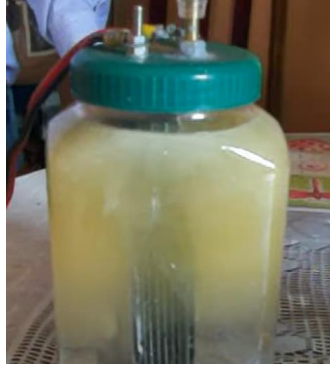
Ilustración 21: Celda electrolítica funcionando con agua corriente
