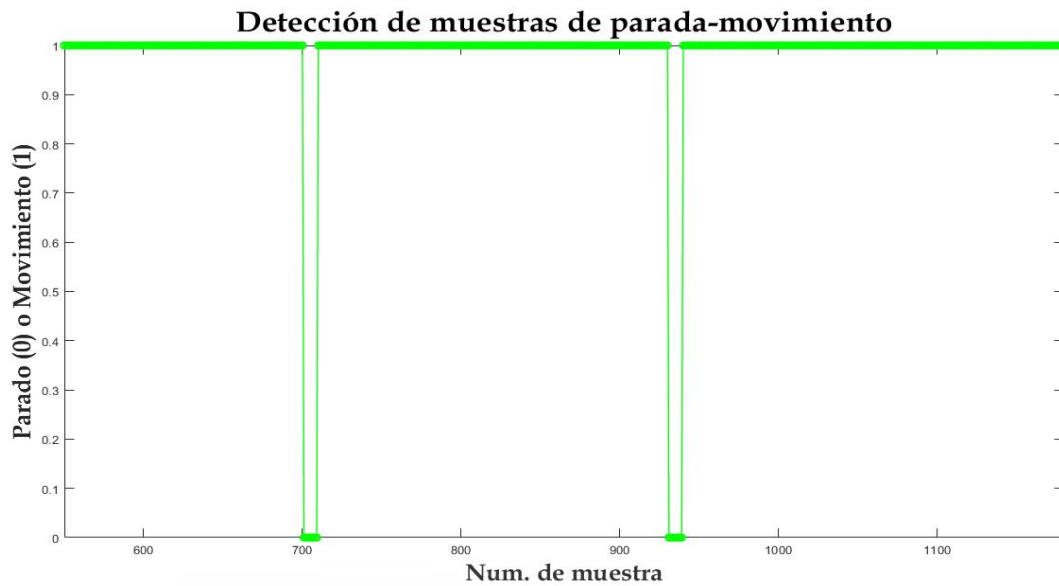
Figura 45. Resultado de la detección de los lapsos de parado-movimiento en un registro del set B.
