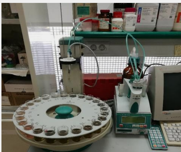
Fotografía 8. Valorador automático Methrom, para calcular la acidez titulable (%).
