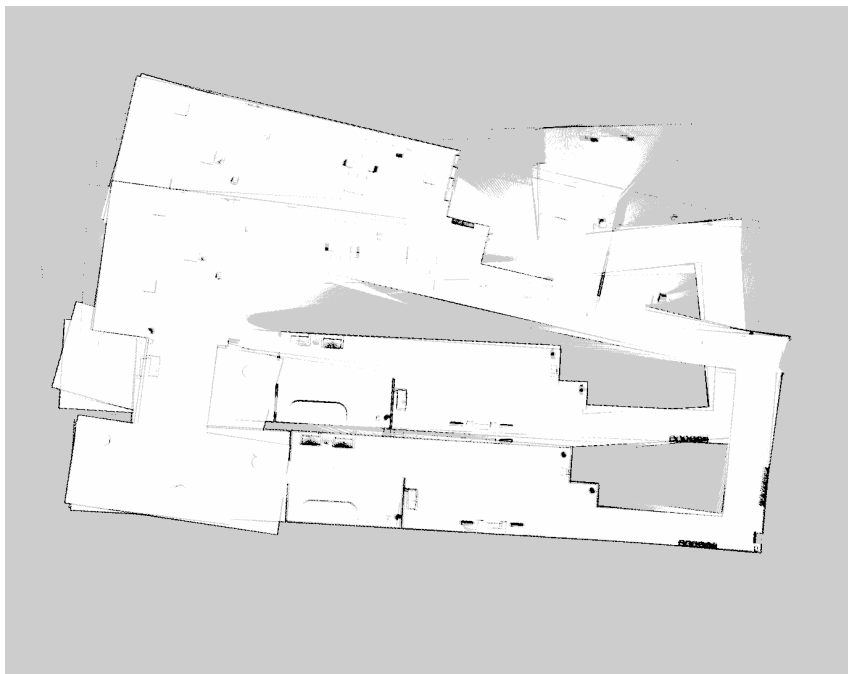
Figura 5.21: mapa de interior simulado generado haciendo uso de la información de PointClouds y odometría
