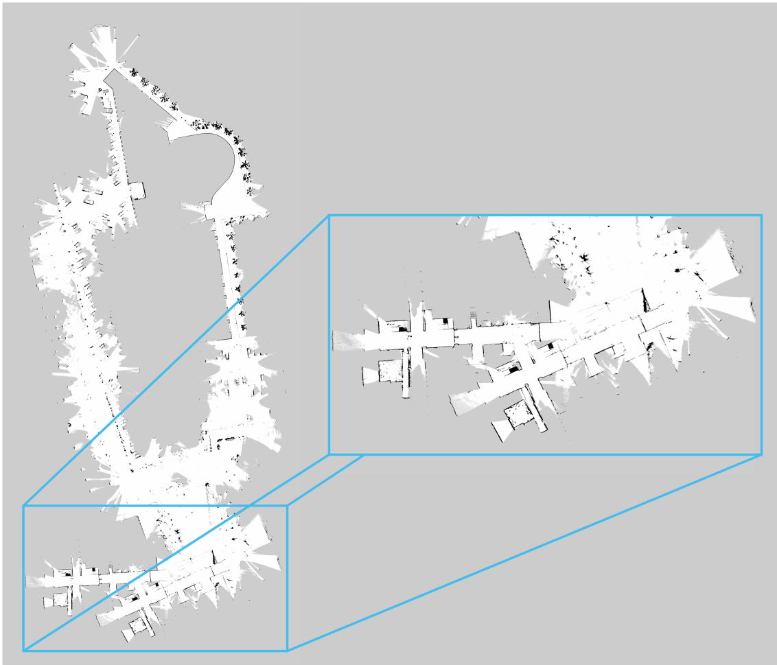
Figura 5.34: mapa de exterior e interior con la plataforma robótica real generado haciendo uso de la información de PointClouds y odometría
