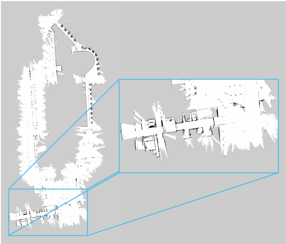
Figura 5.32: mapa de exterior e interior con la plataforma robótica real generado haciendo uso de la información de PointClouds, odometría, IMU y GNSS
