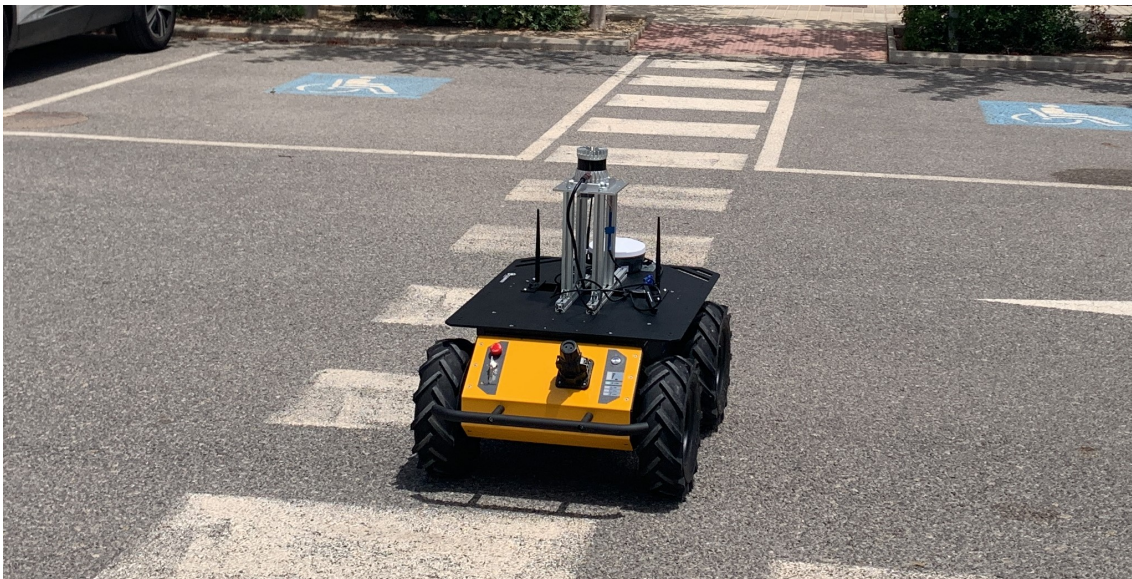
Figura 4.11: plataforma robótica Husky con los sensores instalados
