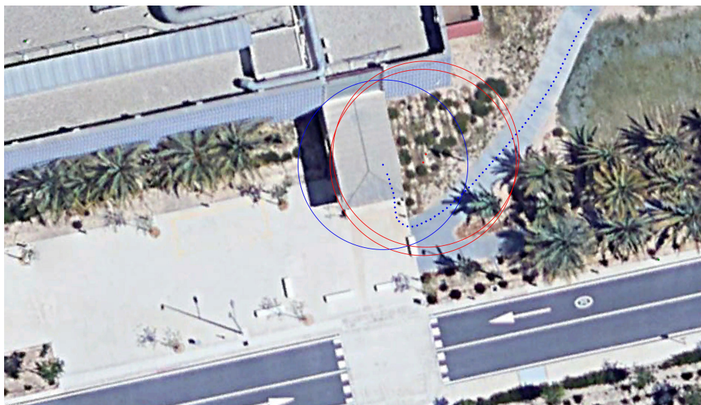
Figura 5.14: detalle pérdida de conexión entre las antenas rover-base a la entrada del edificio
