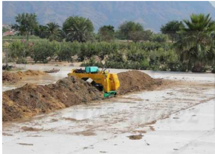
Figura 3.3. Detalle del proceso de volteado de la pila.
