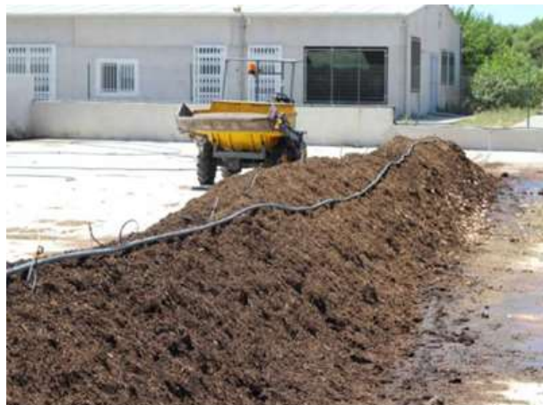
Figura 3.2. Detalle del volquete auto-cargable junto a una de las pilas de compostaje elaboradas.
