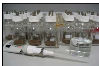
Figuras 29 y 30: Frascos y Respirómetro utilizados para este análisis
