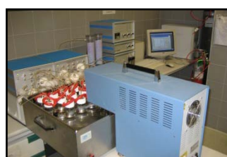
Figuras 29 y 30: Frascos y Respirómetro utilizados para este análisis
