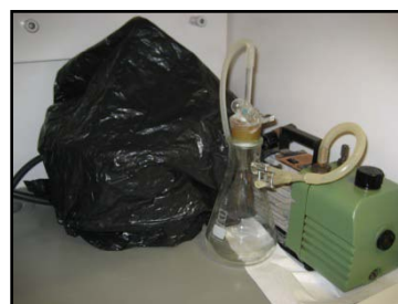
Figuras 27 y 28: Determinación de la Biomasa Microbiana con el método de fumigación
