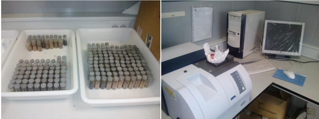
Figura 4. a) Las 136 muestras en viales. b) Espectrofotómetro NIR empleado en la obtención de espectros.
