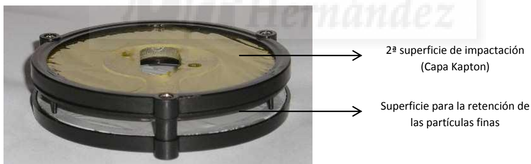
Figura 5. 2ª y 3ª superficies de impactación del Streaker.
