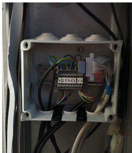
FIGURA 9: Caja estanca del módulo esclavo.
