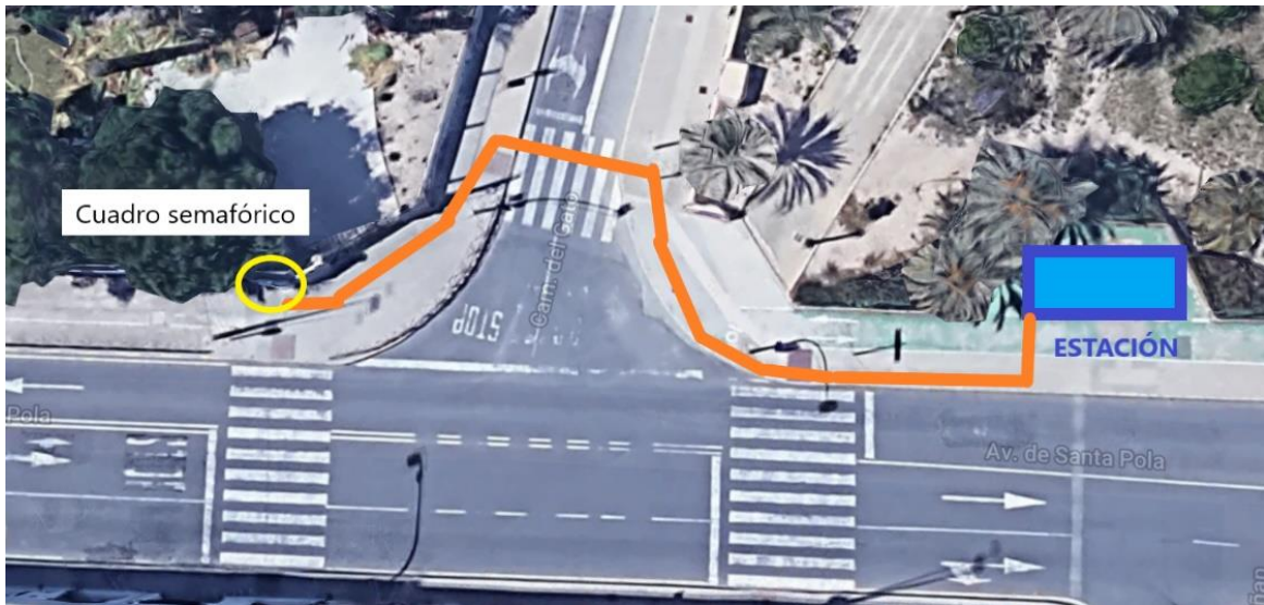
FIGURA 143: Acometida eléctrica de la estación IES Sixto Marco.
