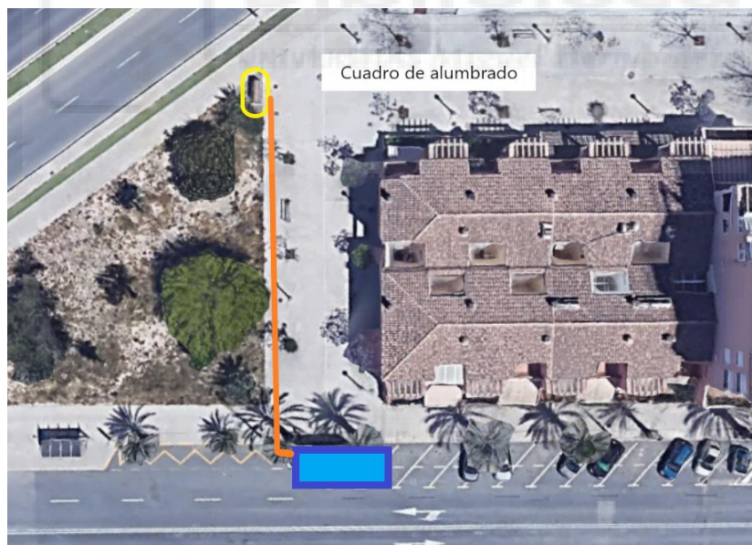
FIGURA 186: Acometida eléctrica desde planta de la estación Alcalde Juan Hernández.
