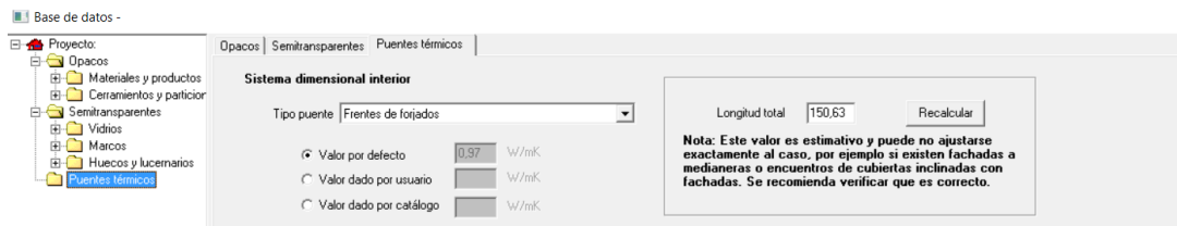
Figura 39: incorporación de puentes térmicos a HULC
