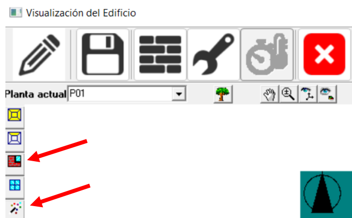
Figura 29: creación de muros (arriba) y forjados (abajo)
