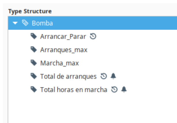
Figura274. Resultado configuración bomba captación. Fuente: Elaboración propia
