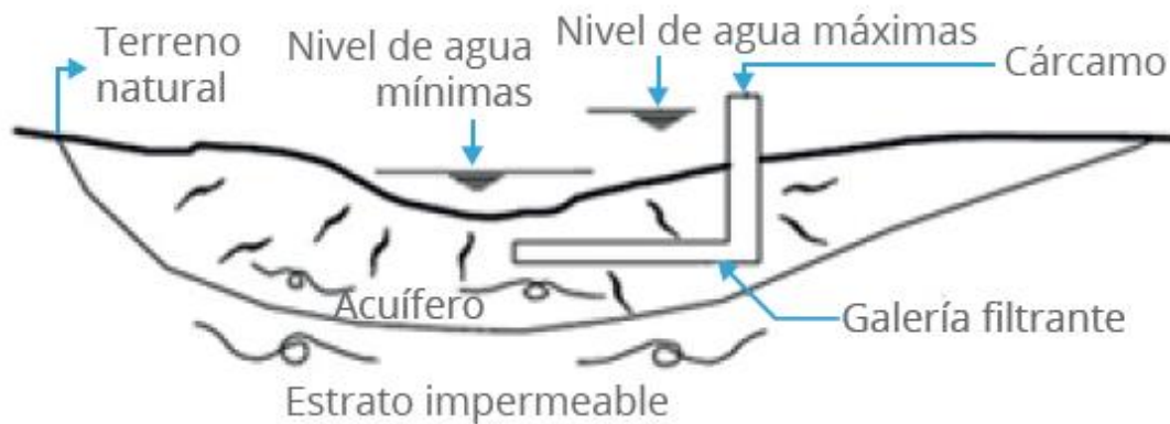
Figura27. Galería filtrante, en este caso, transversal al escurrimiento. Fuente: Comisión Nacional del Agua, México (CONAGUA). Manual de Agua Potable, Alcantarillado y Saneamiento, Obras de Toma
