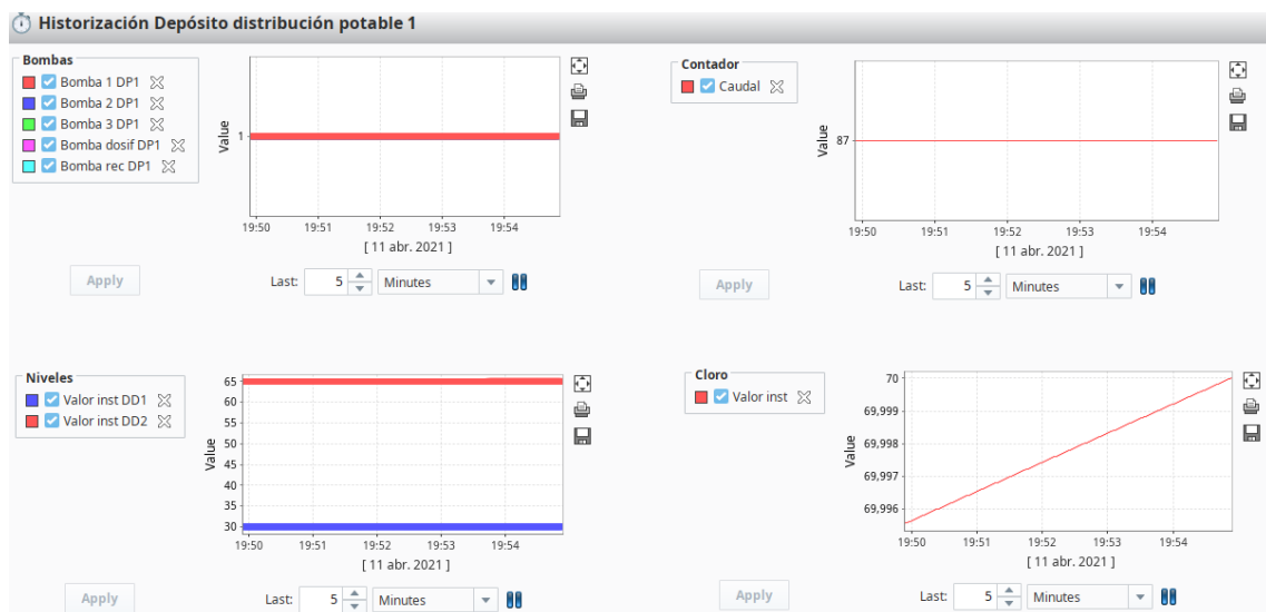
Figura258. Historización depósito distribución 1. Fuente: Elaboración propia
