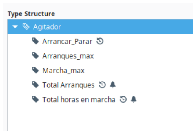
Figura271. Configuración bomba agitadora captación. Fuente: Elaboración propia
