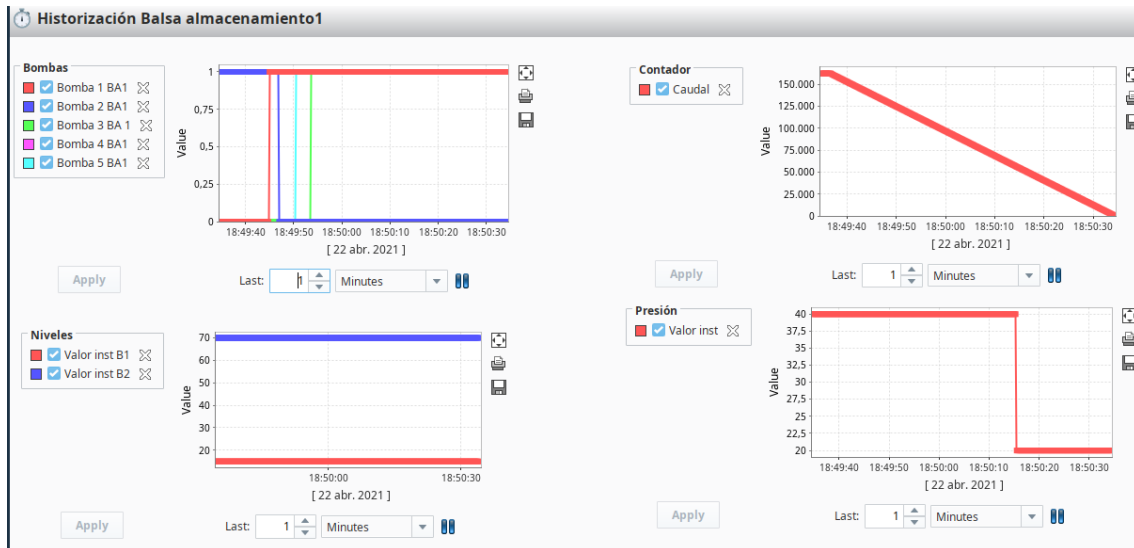
Figura113. Historigrama Balsa almacenamiento 1. Fuente: Elaboración propia
