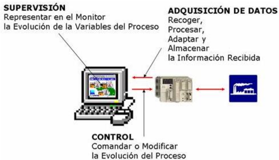
Figura42. Características SCADA: “UPV,2017”
