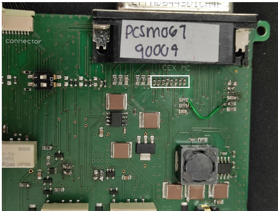
Figura 7: Resistencias de PWM en la PCB
