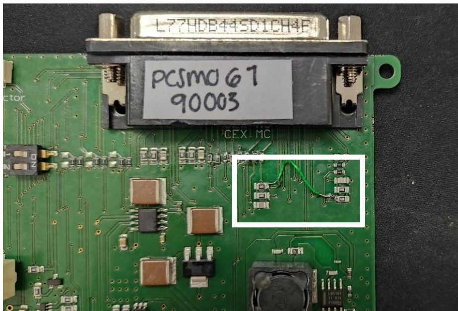
Figura 13: Resistencias de CAN del CEX MC en la PCB
