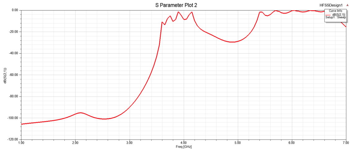
Figura 32. Mejor resultado del barrido paramétrico para la estructura de 5 periodos
