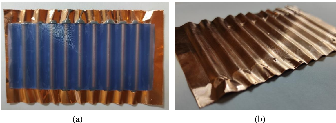
Figura 93. Proceso de metalización. (a) Vista desde la superficie lisa. (b) Vista desde la superficie sinusoidal.
