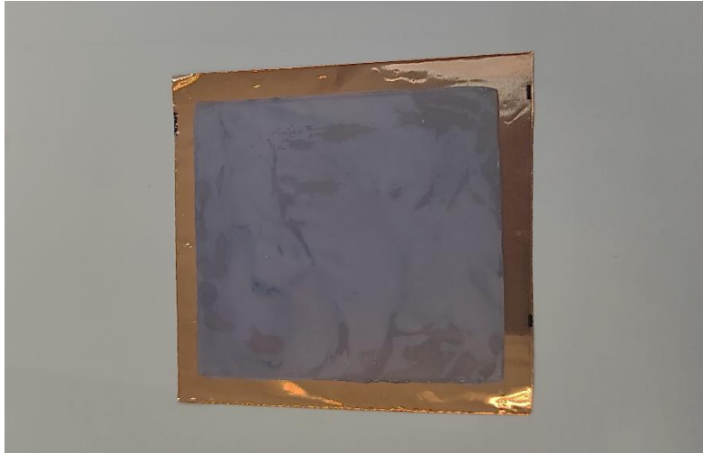
Figura 50. Sustrato adherido al cobre mediante una capa de epoxi.
