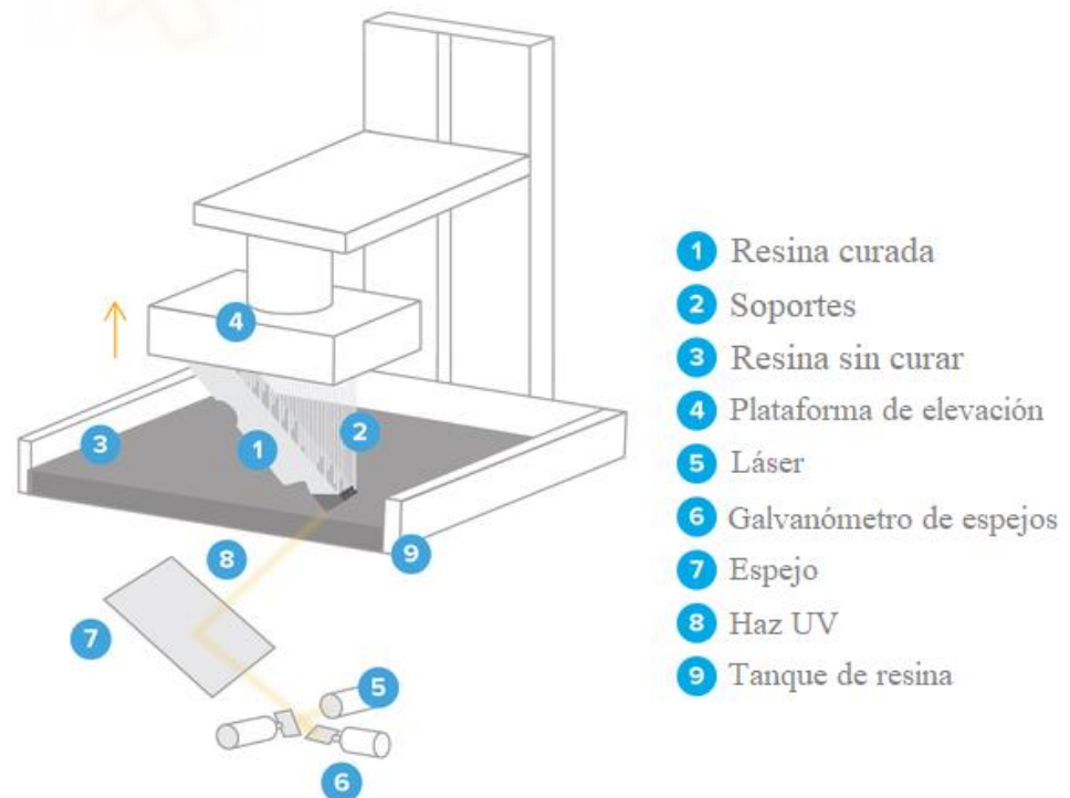
Figura 16. Partes de impresora SLA de abajo a arriba. [16]
