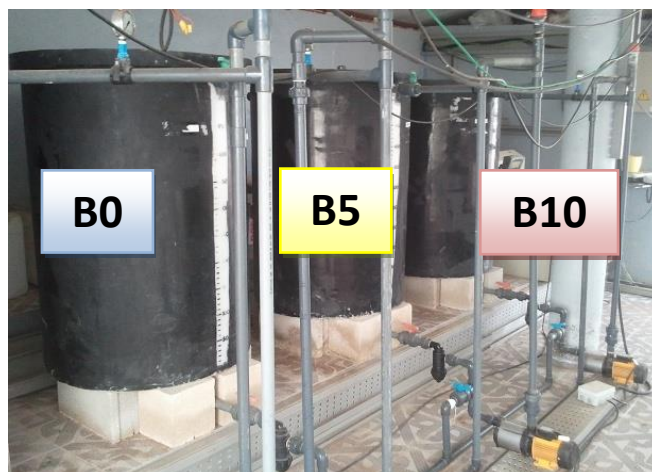
Imagen 5.2. Vista parcial del sistema de riego y de las cubas con los distintos tratamientos de B ( B0 o control : 0,25 \text{ mg L}^{-1} ; B5 : 5 \text{ mg L}^{-1} ; y B10 : 10 \text{ mg L}^{-1} ) que se emplearon para el experimento.
