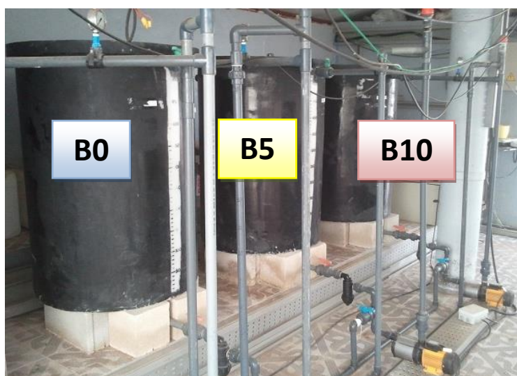
Imagen 4.2. Vista parcial del sistema de riego y de las cubas con los distintos tratamientos de B ( B0 o control : 0,25 \text{ mg L}^{-1} ; B5 : 5 \text{ mg L}^{-1} ; y B10 : 10 \text{ mg L}^{-1} ) que se emplearon para el experimento.
