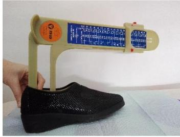
Figura 2: Medición longitud del calzado
