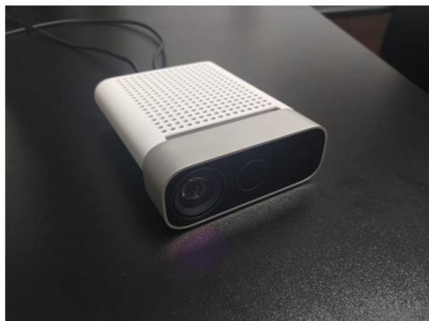
**Figura 4: Cámara Azure Kinect:** imagen de la cámara de captura de movimiento Microsoft Azure Kinect.
