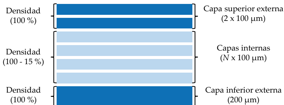
Figura 2.6 Estructura de las capas impresas de una pieza 3D.
