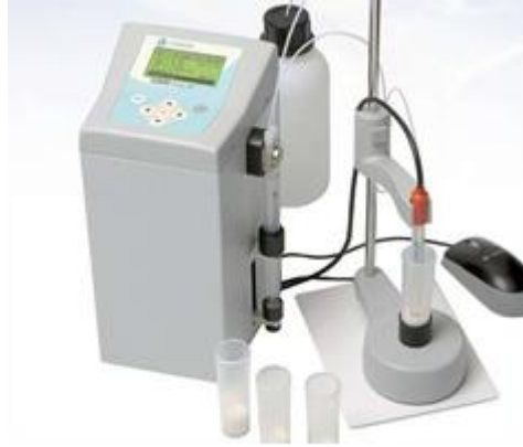
Figura 20: pHmetro pHmatic 23 CRISON utilizado para medir la acidez.
