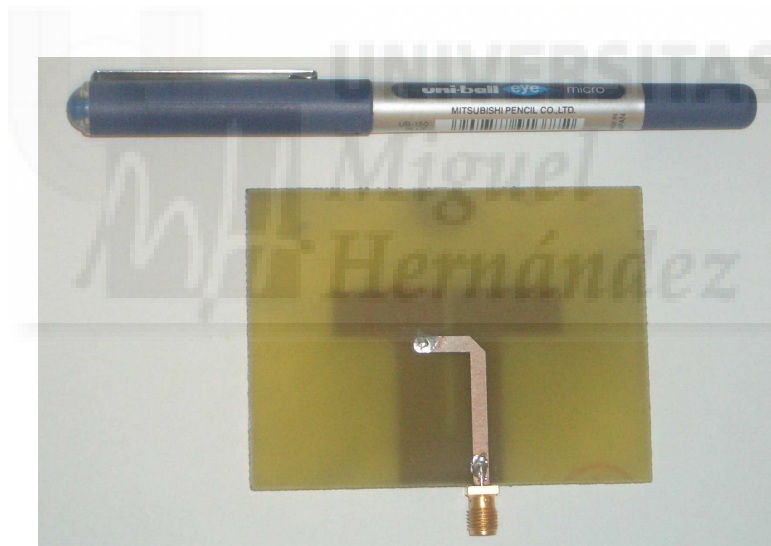
Fig. 8.4 – Antena dipolo con alimentación balanceada para aplicaciones Wi-Fi.
