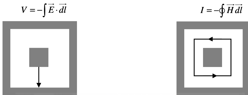
Fig. 2.6 – Esquema de cálculo de la tensión y la intensidad cuando la alimentación de la antena se realiza mediante un cable coaxial cuadrado.
