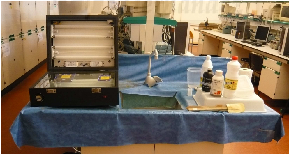
Fig. AI.1 – Elementos utilizados en la fabricación de las antenas impresas mediante ataque químico.
