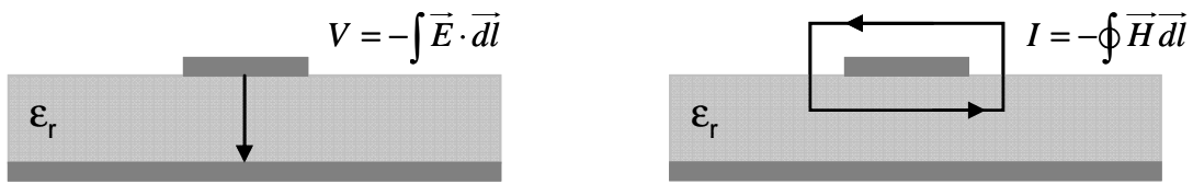
Fig. 2.5 – Esquema de cálculo de la tensión y la intensidad cuando la alimentación de la antena se realiza mediante una línea microstrip.
