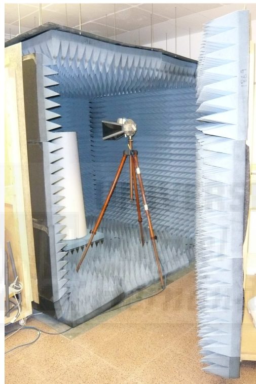
Fig. AI.8 – Cámara anecoica instalada en el laboratorio.
