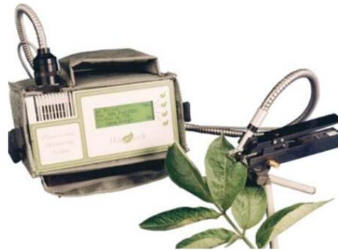
Fotografía 3.8. Equipo portátil de fluorescencia empleado para hacer las medidas de parámetros.
