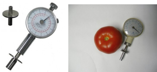
Fotografía 3.5 Penetrómetro empleado para medir la dureza.
