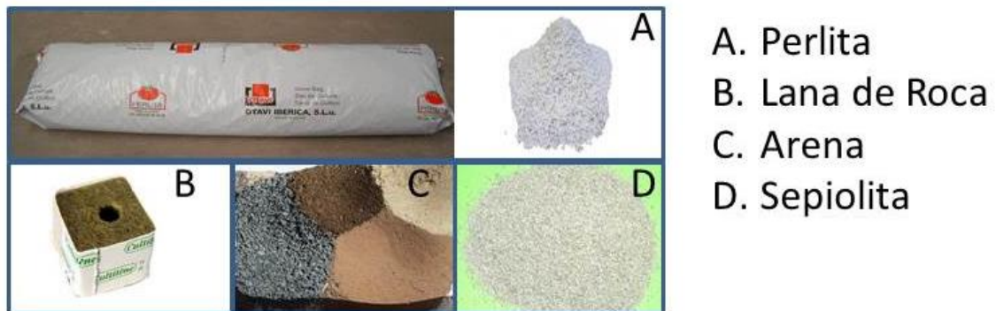
Fotografía 1.2. Detalle de sustratos inorgánicos (perlita, lana de roca, arena y sepiolita).
