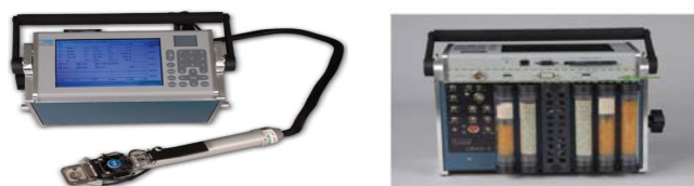
Fotografía 3.7. Equipo portátil de fotosíntesis empleado para hacer las medidas de intercambio gaseoso.
