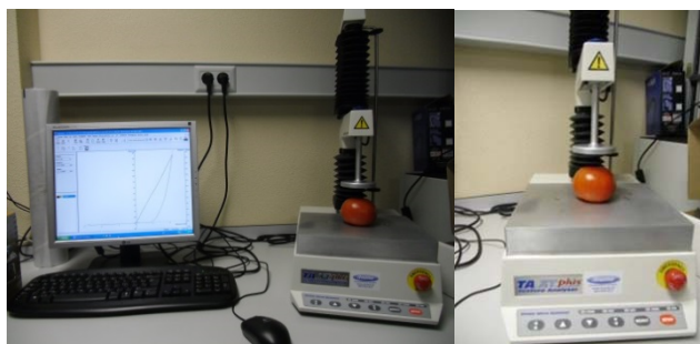
Fotografía 3.6. Texturómetro empleado para medir la firmeza.
