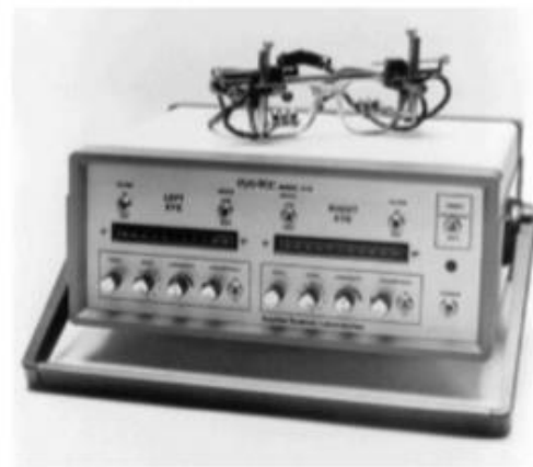
(b) Ejemplo de aparato de rastreo de limbo esclerocorneal por infrarrojos.
