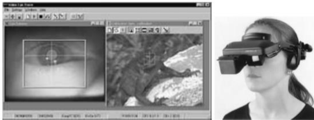
Figura 5.5: Ejemplo de eye-tracker de video montado en la cabeza. (Duchowski, 2003)
