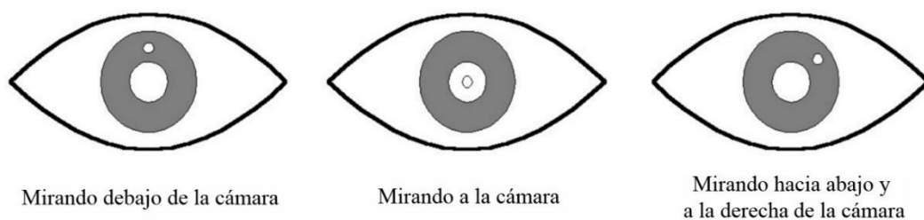
Figura 4.7: La posición del reflejo corneal cambia según el punto de observación. (cf. Redline & Lankford, 2001)
