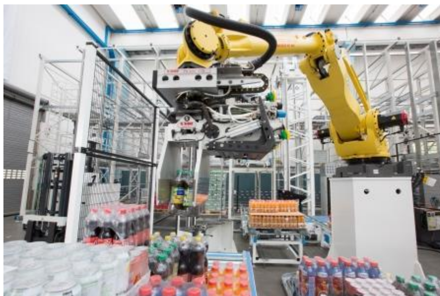
Imagen 11. Máquina con sistema “Schäfer Case Picking” paletizando.
