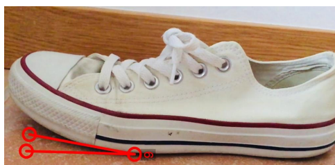
Imagen 7. Ejemplo medición quebrante de puntera.
